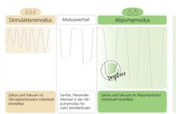
In der "DropZone" wird ein stabiles Vakuum auf eingestellter Höhe gehalten. Das fördert das kontinuierliche und ungehinderte Fliessen der Muttermilch. Besonders bei einem tiefen Zyklus hilft die "DropZone" effizient abzupumpen, weil die Milch mehr Zeit hat zu fliessen.
